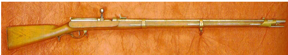
Fusil de Infantería, modelo 1840, calibre 15,43 mm.; longitud 1.430 mm.
